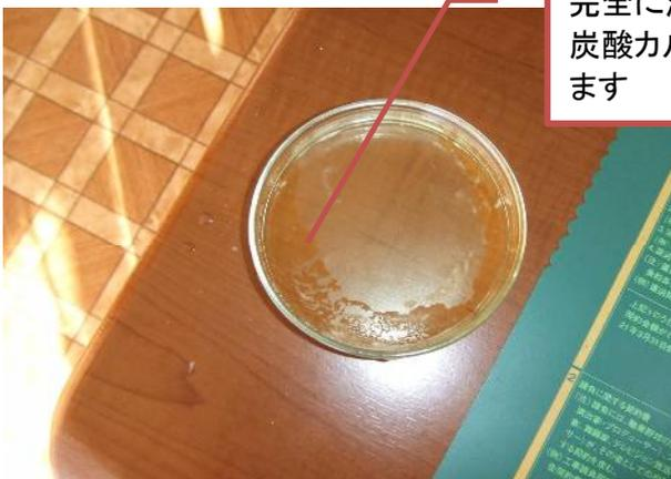
完全に溶解しております。漬け置きでも炭酸カルシウムには溶解効果が見込めます
